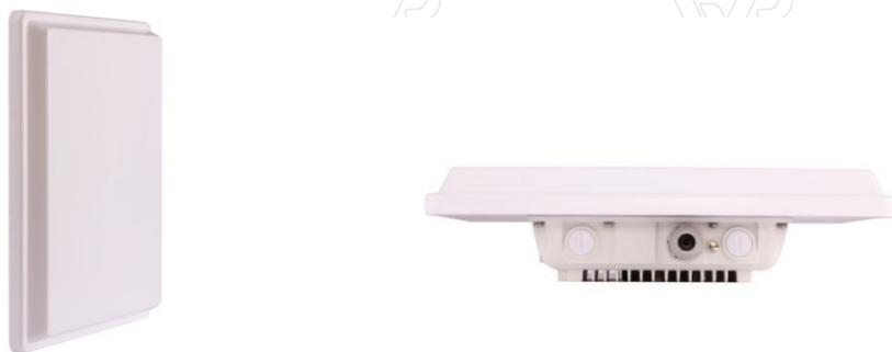
Doublecom DB6000ACLST25-Pro是一款支持802.11ac标准的大功率、高带宽、高性能的5.8GHz工业级天线一体化无线网桥,该设备射频部分基于MIMO(多进多出)技术,采用了2T2R的构架,无线频宽支持20/40/80MHz,物理层带宽866Mbps,该设备最大发射功率1000mw,接收灵敏度高达-96dBm,内置25dBi定向双极化天线,建议桥接距离10~20公里,同时该设备采用1000M网口设计,实际吞吐量最大可达350Mbps以上,全面超越百兆有线速率,可满足中等距离高带宽无线联网的需求。
